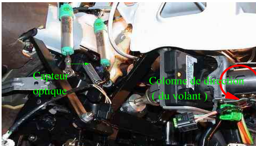
Illustration 3.7 : Prise de mesure de l'angle du volant par capteurs optiques (vue large)
