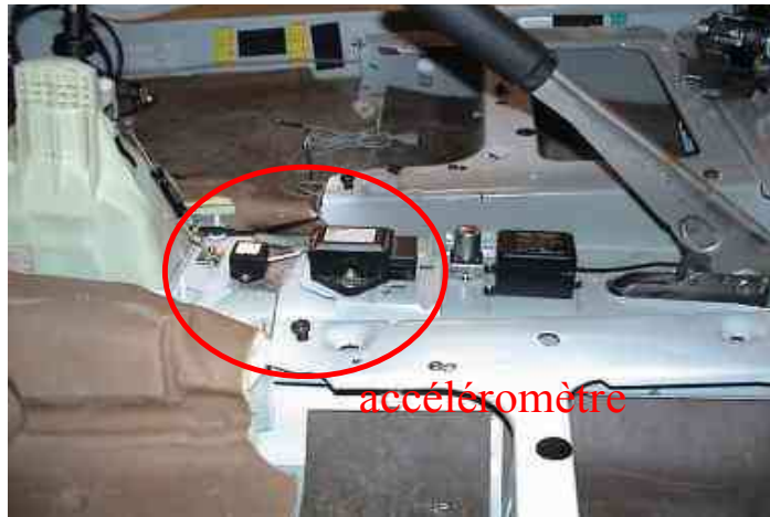
Illustration 3.10 : Mesure de l'accélération du véhicule
