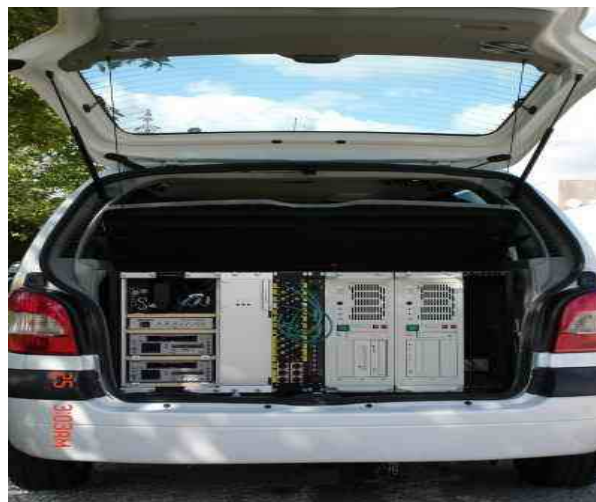
Illustration 3.11 : Ordinateurs embarqués permettant d'effectuer l'enregistrement des données.
