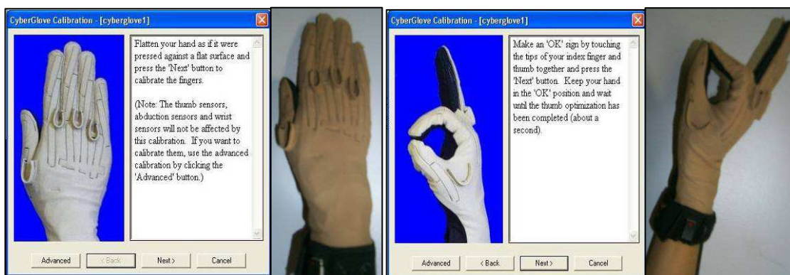
Figure 2.25. La phase de calibration rapide du gant
