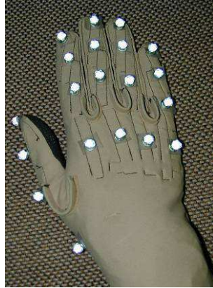
Figure 4.1. Le gant sensitif et le positionnement des marqueurs
