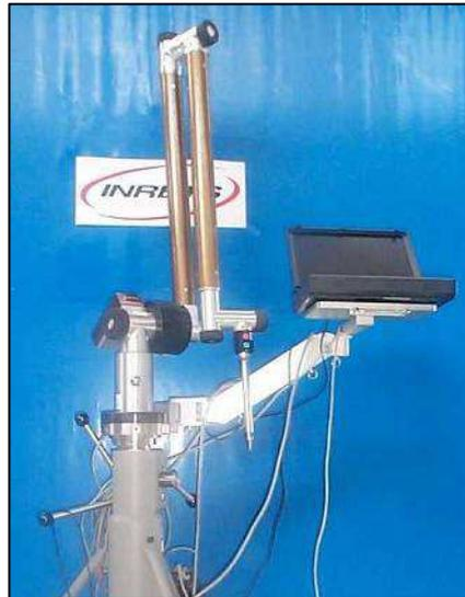
Figure 2.22. Le dispositif de mesure Faro Arm
