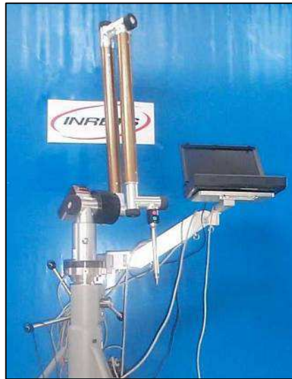
Figure 2.22. Le dispositif de mesure Faro Arm
