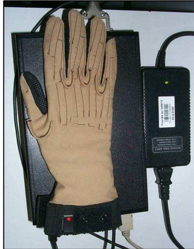
Figure 2.23. Le gant sensitif CyberGlove
