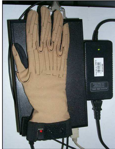
Figure 2.23. Le gant sensitif CyberGlove
