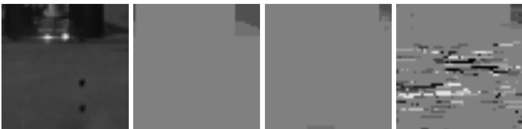
FIG. 2.16 : Comparaison qualitative de résultats de disparité obtenus pour la sous-image (D) par la mesure SSD (Sous-image (D) - Vérité-terrain associée - Disparités obtenues avec une fenêtre carrée 11 \times 11 - Disparités obtenues avec une fenêtre ligne 11 \times 1 ).
