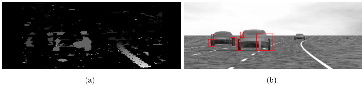
FIG. 4.22 : (a) Carte des disparités obtenues avec notre méthode 1D avec T_{dec} = 0.7 et une hauteur de fenêtre de 5 pixels, (b) Boîtes englobantes obtenues sur la carte des disparités (a) (ici, la caméra droite est inclinée vers la chaussée d'un angle de 0.1 degré).
