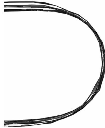
Figure 5.2: Essai MHA115. A gauche : Courbes de pénétration et de déplacement pour le point central de la ceinture ; à droite : Vue de dessus de la ceinture à différents instants : état initial,  $t=20$  ms,  $t=30$  ms,  $t=40$  ms,  $t=60$  ms superposés sur les extrémités des brins de la ceinture.
