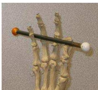
**Figure 3.4: Baguette étalon utilisée pour l'évaluation de la précision de la méthode de reconstruction.**
