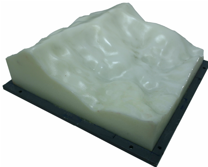
Figure 2-9 : Photo d'un contre-moule de 22 cm x 20 cm et servant à la réalisation de modèles en trois dimensions basés sur des topographies réalistes. C'est ici une portion de la Matter Valley centrée sur la falaise du Grossgauer.
