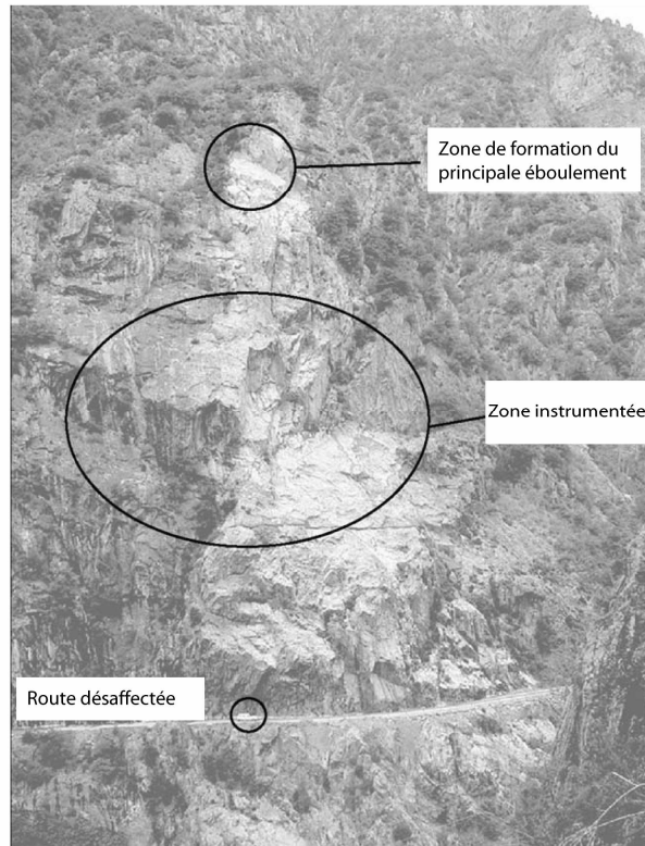
Figure 1-10 : Les Rochers de Valabres d'après Gunzger et al., 2005 (modifié). L'échelle de la photographie est donnée par une voiture sur la route passant au pied du versant et aujourd'hui désaffectée
