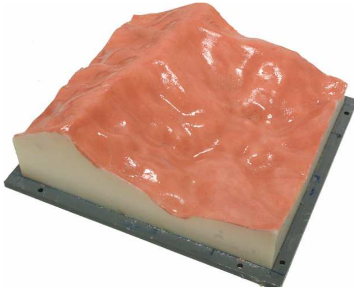
Figure 2-12 : Photographie d'un contre-moule de 22 cm x 20 cm recouvert d'une pellicule de silicone de moulage.
