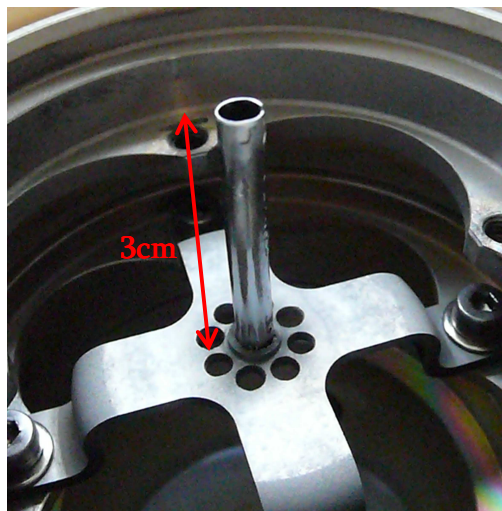
Fig. 58 _ Photo du tube ioniseur en rhénium. Diam. Int. 4 mm. Ep. Feuille 125 \mu m.
