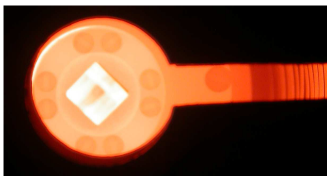
Fig. 83 _ Vue au travers du hublot placé à l'arrière du four. Il est possible de distinguer l'entrée du tube de transfert (carré lumineux au centre), les 8 vis de connexion du tube et une partie du circuit four (stries à droite de l'image). La vue est limitée à un cercle central et une fente réalisés dans une feuille de Papyex servant d'écran de protection au hublot.
