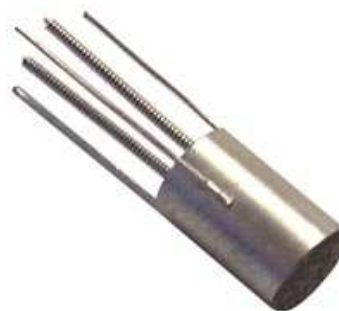
Fig. 136_ Photo d'un émetteur d'alcalins utilisé dans le canon à ion.
