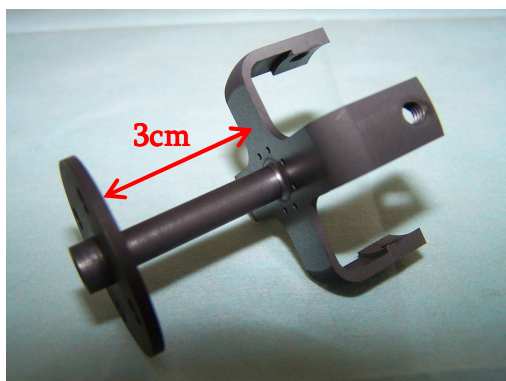
Fig. 57 _ Photo du tube ioniseur en carbone. Diam. int. 4 mm. Diam. ext. 6 mm.
