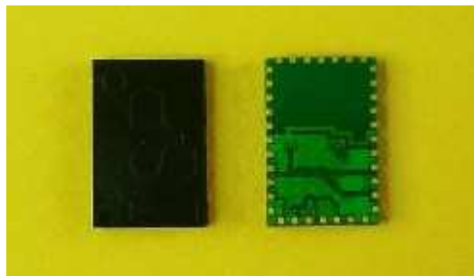
FIG. 1.7 – Photographie d'un module SiP sur substrat laminé FR4 avec surmoulage, vue de dessus et vue de dessous
