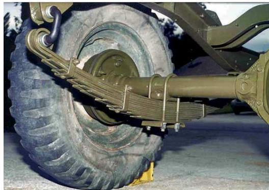
FIG. 2.1 – Suspension d'essieu à ressort à lattes avec dissipation par frottement sec entre les lattes.
