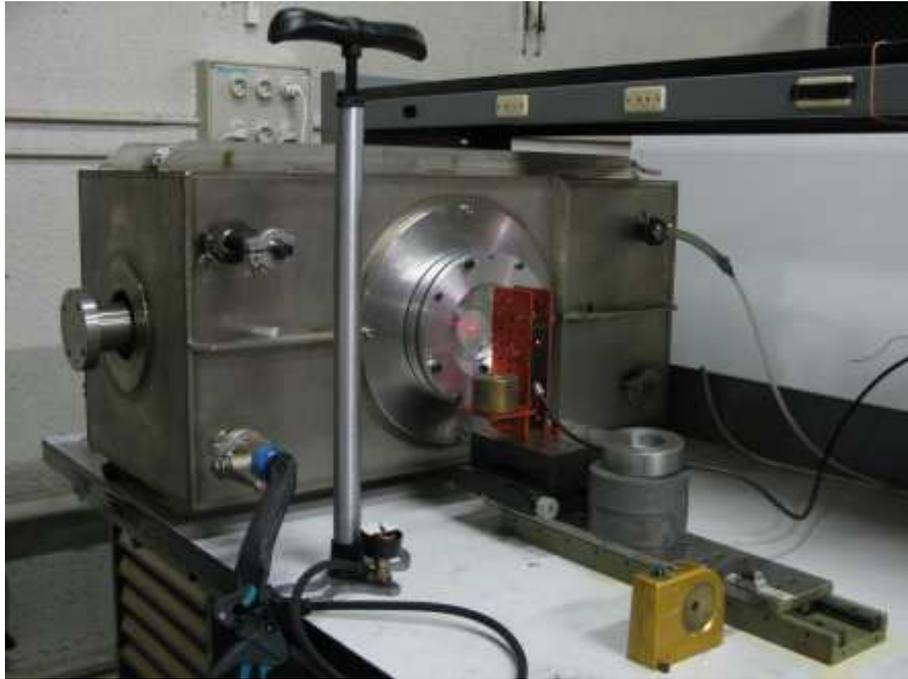
FIG. 3.4 – Photographie du montage expérimental de caractérisation de la raideur des membranes.
