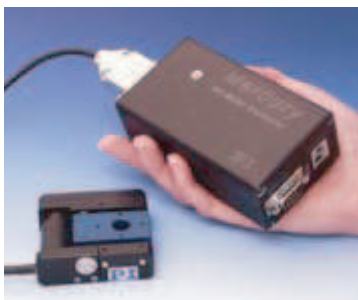
FIG. 3.13 – Photo du moteur contrôleur PI (M-111.1DG) branché à la mercury C-860.10.
