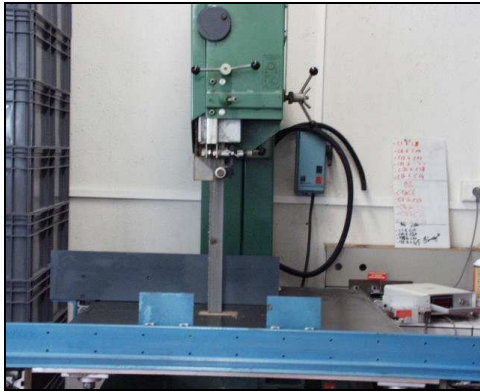
Figure 84: Scie utilisée (à gauche) et bloc en position pour la coupe (à droite).
