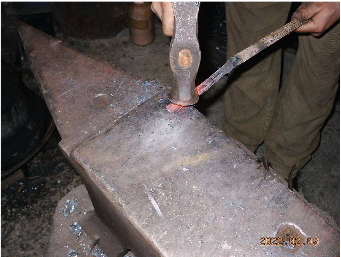
F - Enroulage et finition de la douille
