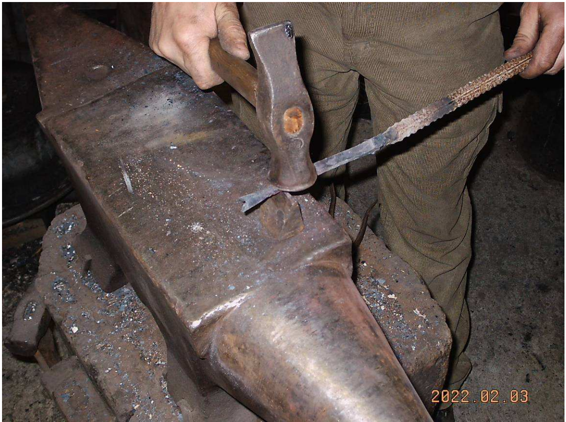
G - La douille est séparée de la barre à l'aide du tranchet
