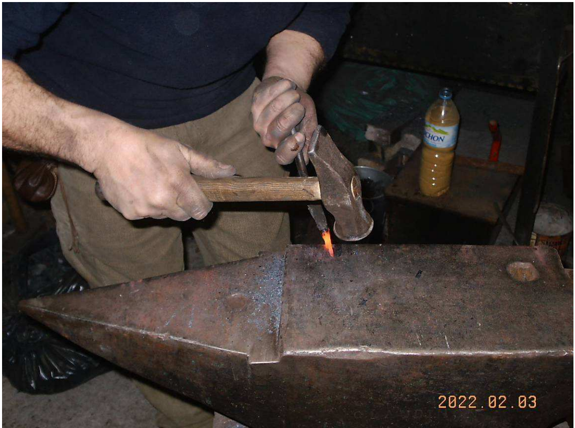
I - Fabrication et finition de la barbelure
