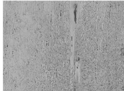
500 μm Fig. 6 Micrographie optique. Liseré blanc matérialisant la soudure de la barbelure
