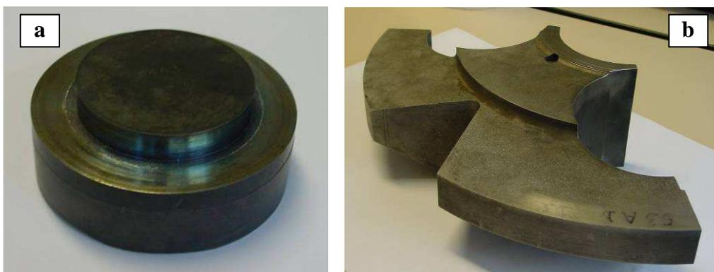
**Figure A.12. :** *a) Brut de disque de turbine HP pour applications aéronautiques.
