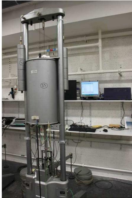
**Figure A.29. :** *Machine de fluage sous air Adamel double ligne.*
