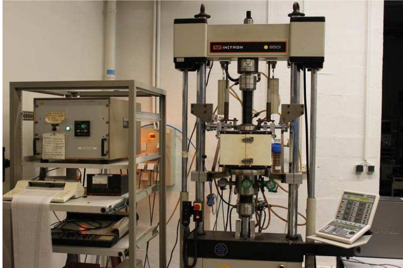
**Figure A.30. :** *Machine de fatigue hydraulique sous vide Instron 8501.*
