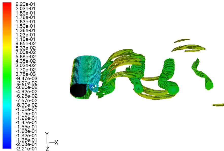
FIG. 4.5 – Isosurface de critère  $Q$  [24] colorée en pression statique, dans le sillage d'un cylindre circulaire à un nombre de Reynolds de 616. Les structures tridimensionnelles rappellent celles décrites par Thomson et al. [9].
