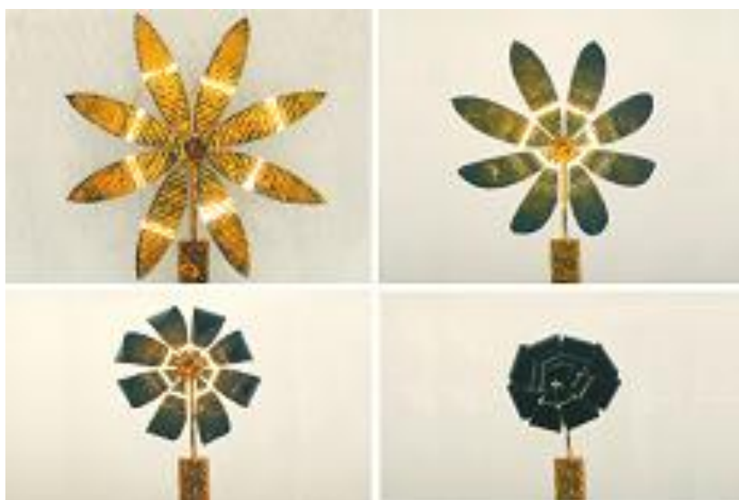
Figure 1.4. "Fleur" micro-origami à base de polymère conducteur par Smela et al. [13, 14].
