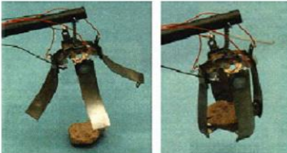
Figure 1.3. Exemple de pince composée de quatre bras indépendants réalisés en IPMC.
