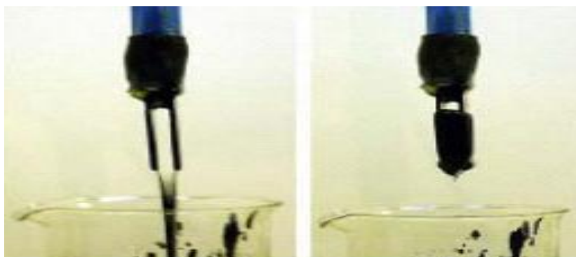
Figure 1.8. Fluide électrorhéologique : à l'état initial (à gauche) et à l'état actionné (à droite) [23].
