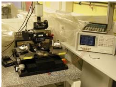
Figure 3.15. Station sous pointe et impédance-mètre.
