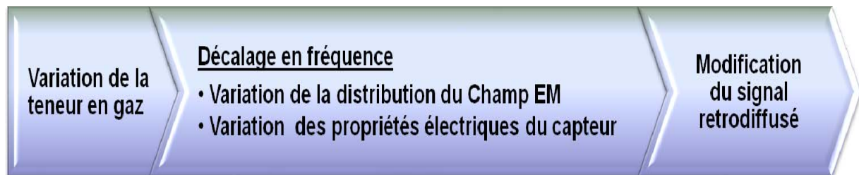
Figure 20. Relation établie entre la variation de fréquence de résonance du capteur à la présence de gaz et son impact sur le signal rétrodiffusé sur le radar.
