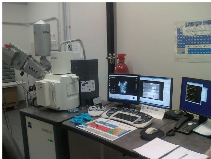
Photographie du Microscope électronique à balayage utilisé pour l'analyse d'un ruban
