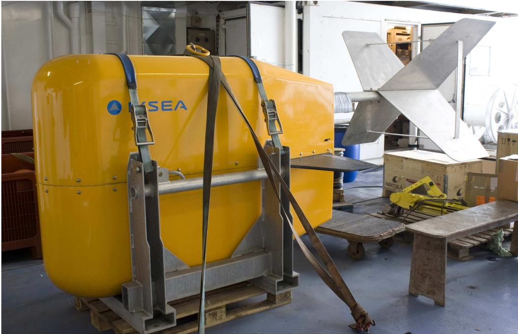
FIGURE 3.2 : Photo de la source acoustique à profondeur variable utilisée lors de la campagne BASE'07 (photo prise par Nicolas Josso).
