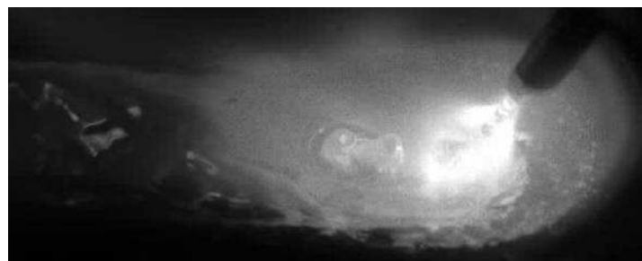
Figure 49 : Observation de l'arc en régime spray ( V_f = 8 \text{ m/min} et U_0 = 2 \text{ m/min} )
