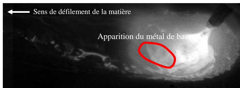
Figure 73 : Visualisation du métal de base dans le bain de fusion (Vitesse fil = 8 m/min, Vitesse de soudage = 1 m/min)
