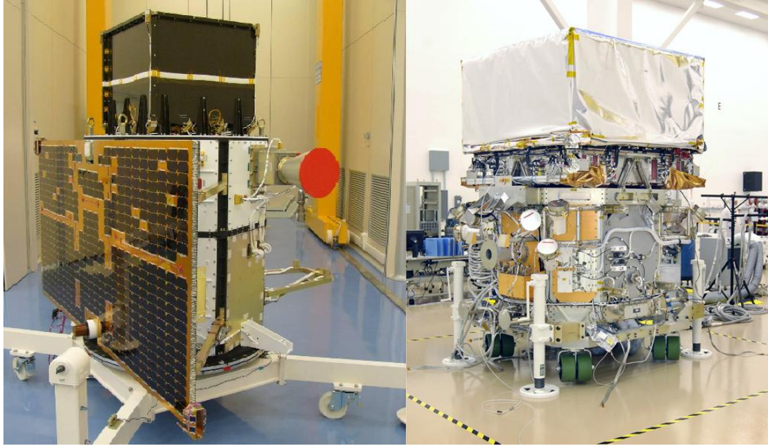
FIG. III.3 – Gauche : Vue latérale du satellite Astrorivelatore Gamma and Immagini LEggero (AGILE). L'instrument Gamma-Ray Imaging Detector (GRID) est visible dans la partie supérieure de l'image. Droite : Vue latérale du satellite Fermi Gamma-ray Space Telescope (anciennement Gamma-ray Large Area Space Telescope ou GLAST). Le Large Area Telescope (LAT) est situé dans la partie supérieure du satellite.
