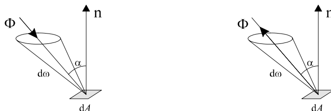
Fig. 235. Schématisation de la luminance arrivant sur une surface d'aire élémentaire dA (à gauche), ou la quittant (à droite) ; à relier aux schémas de l'éclairage et de l'éxitance de la Fig. 232.
