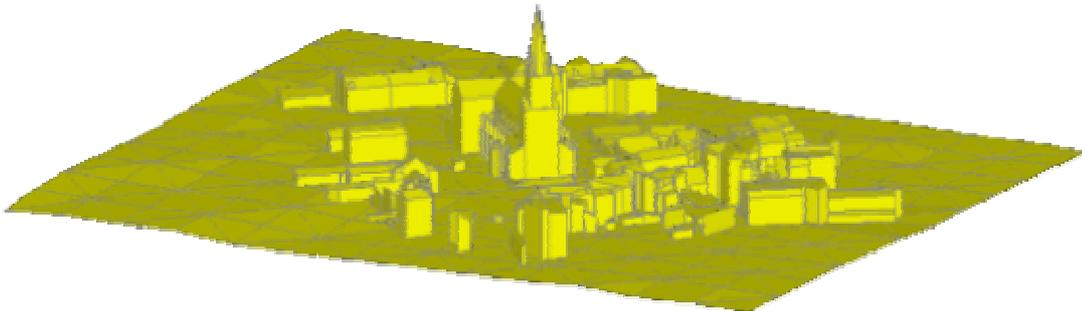
Fig. 7. Simulation héliodon, correspondant à une observation selon la direction du soleil pour un observateur situé à l'infini, le 21 décembre à 10 h ; toutes les surfaces vues de cette scène urbaine sont donc éclairées directement par l'astre solaire.
