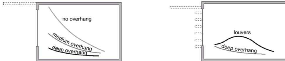
Fig. 40. Sans débord de toiture, le gradient est élevé (éclairage important près de l'ouverture, diminuant très rapidement avec la profondeur) ; le débord permet d'éviter l'éblouissement au voisinage de la fenêtre et conduit à une répartition plus homogène (à gauche). Scinder le débord autorise une répartition encore plus homogène (à droite).
