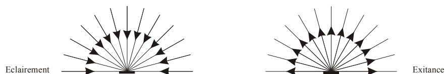
Fig. 232. Schématisation de la différence entre éclairement et exitance.
