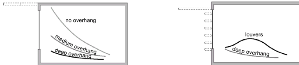
Fig. 40. Sans débord de toiture, le gradient est élevé (éclairage important près de l'ouverture, diminuant très rapidement avec la profondeur) ; le débord permet d'éviter l'éblouissement au voisinage de la fenêtre et conduit à une répartition plus homogène (à gauche). Scinder le débord autorise une répartition encore plus homogène (à droite).
