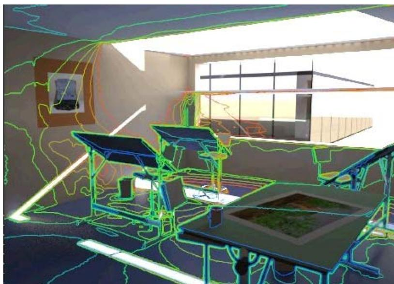
Fig. 79. RADIANCE : contours d'isoluminance superposés au rendu « photoréaliste » ;
