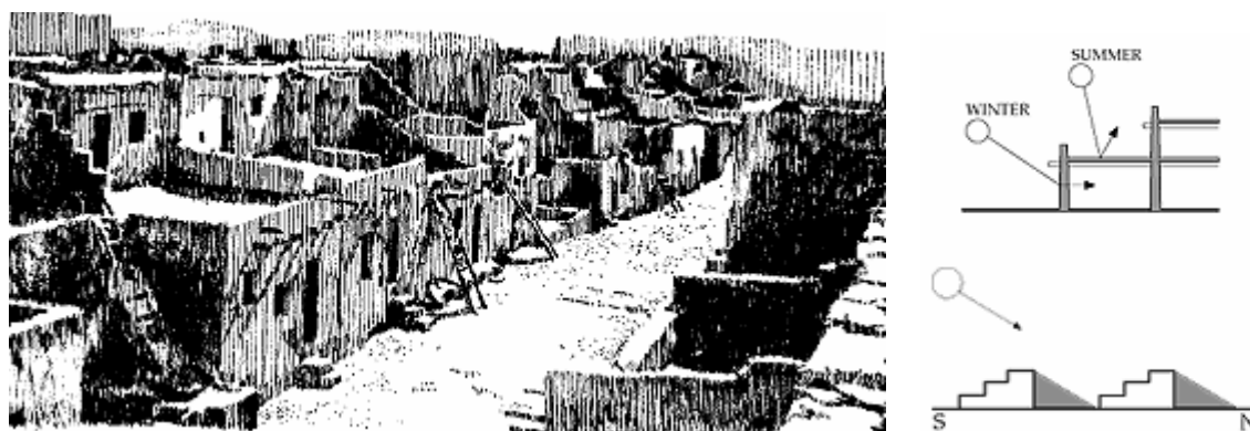
Fig. 24. Acoma Pueblo ; l'épaisseur des murs en maçonnerie est importante, alors que les toits et les terrasses sont constitués de poutres de bois recouvertes de roseaux qui sont liés par un mortier d'argile et d'herbes.
