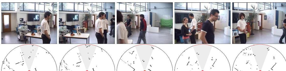
(b) Séquence #2 impliquant jusqu'à cinq personnes simultanément, de brèves occultations et un arrière-plan très encombré. Le robot est en mouvement.
