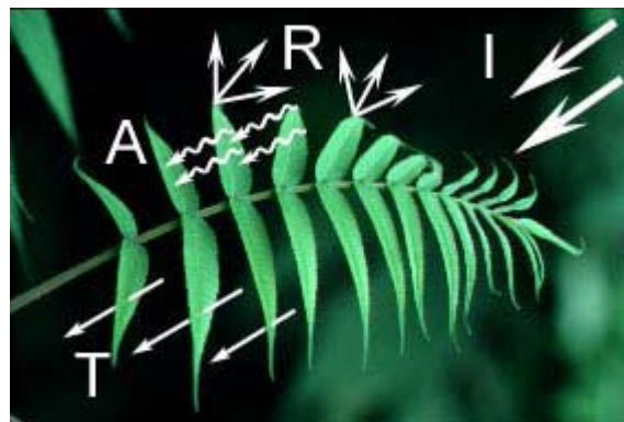
Figure A.3 Interaction du rayonnement avec la surface (Noter que selon le premier principe de la thermodynamique, la somme des énergies réfléchies, absorbées et transmises est égale à l'énergie incidente.)
