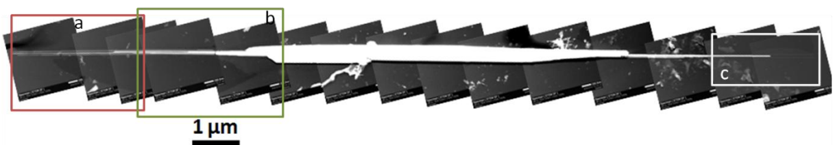
Figure V.2 – Montage d'images STEM le long d'un nanobâtonnet avec les zones agrandies encadrées.
