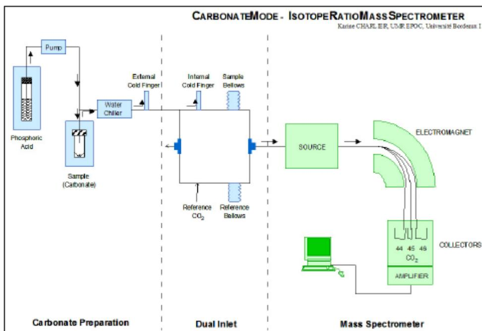
Figure III. 2 Schéma de principe de fonctionnement du spectromètre de masse utilisé pour l'analyse des isotopes stables (extrait de (Couchoud, 2006))
