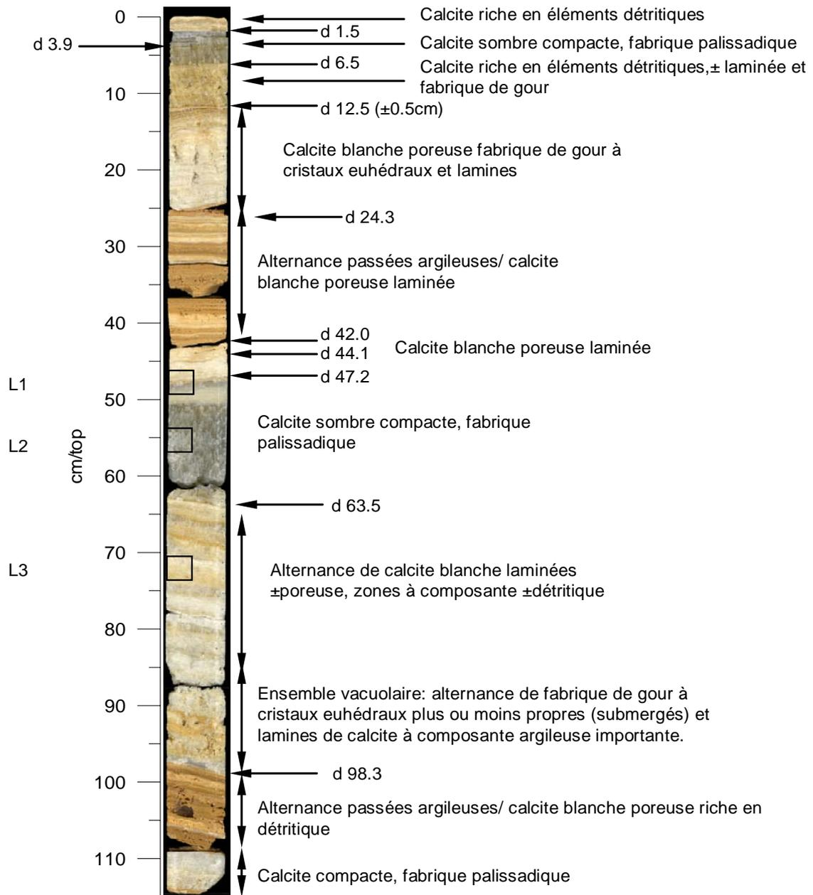
**Figure IV. 1** Section polie du carottage Vil-car-1 et description des différents types de dépôts
