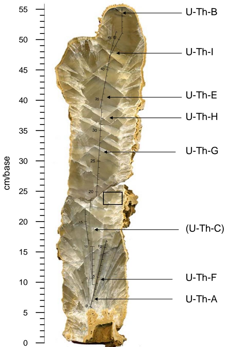
**Figure IV. 36** Section polie de la stalagmite Max2 : axes de croissance et localisation des analyses U-Th. L'origine de l'axe de référence est située à la base. Le pourtour rectangulaire noir matérialise les contours de la lame mince.
