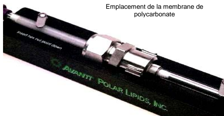
Figure 70. Photo de l'extrudeur. Il est composé d'un porteur en téflon contenant deux seringues Hamilton de 250 µl chacune qui se font face et qui sont reliées par un système permettant d'insérer une membrane en polycarbonate dont le diamètre du pore est calibré (50, 80, 100 ou 200 nm).
