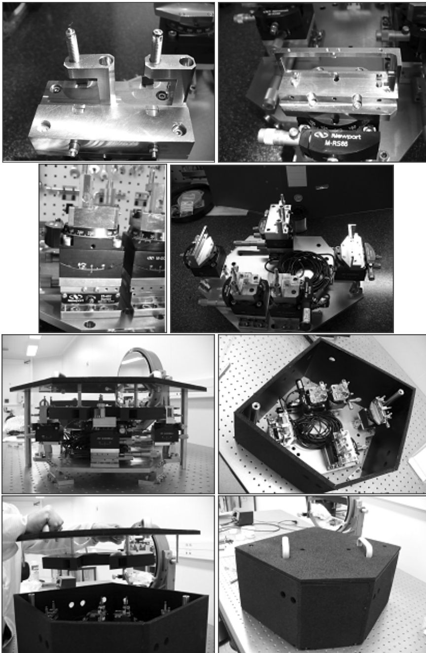
Figure E.1 - Photos de la mécanique du MMZ. De haut en bas et de gauche à droite : monture des lames L4, monture des miroirs, monture des lames L3, MMZ complet, couvercle et bafflage en place sur les colonnes, capot, mise en place du capot, capot fermé.
