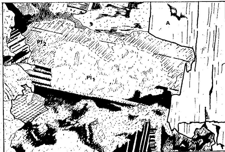
Fig. 94 (x195) - Olivine déstabilisée par une biotite (chloritisée) de première génération, puis par une amphibole de deuxième génération.
