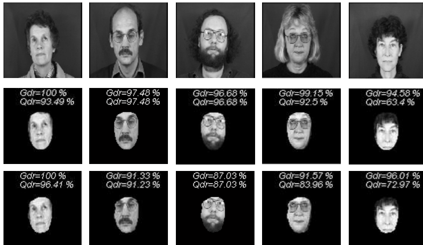
Figure 2.13 : Résultats de localisation et valeurs de Gdr et Qdr obtenus pour des images de la base XM2VTS. En haut, images d'origine. Au milieu, localisation par l'algorithme utilisant les moments de Zernike. En bas, localisation par les Eigenfaces .
