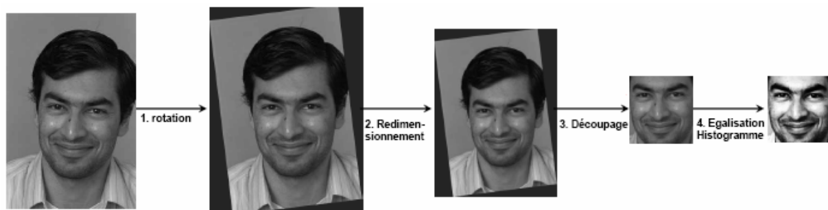
Figure 2.15 : Le processus de normalisation des images compte quatre étapes : la rotation, le redimensionnement, le découpage, et l'égalisation d'histogramme.
