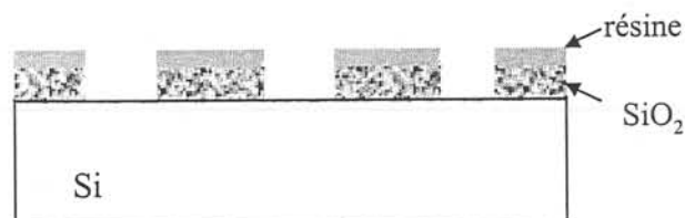
Figure II. 9 : Ouverture du masque de gravure
