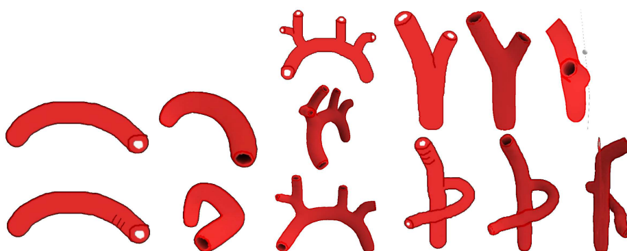
FIGURE 6.7 – Inférence 3D à partir de dessin 2D. Le processus de modélisation 3D est complètement automatique et n'utilise que les informations contenues dans le dessin. L'utilisateur dessine seulement. A noter que cela est réalisé en temps réel.
