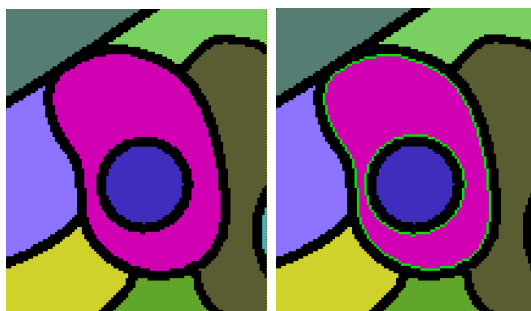
FIGURE 4.7 – Sur la gauche, l'image initiale et sur la droite représenté en vert, le contour extrait à partir de la carte de distance. Carte de distance réalisée avec le masque de chanfrein d_{5,7,11} (extrait de la coupe 147 colorée).
