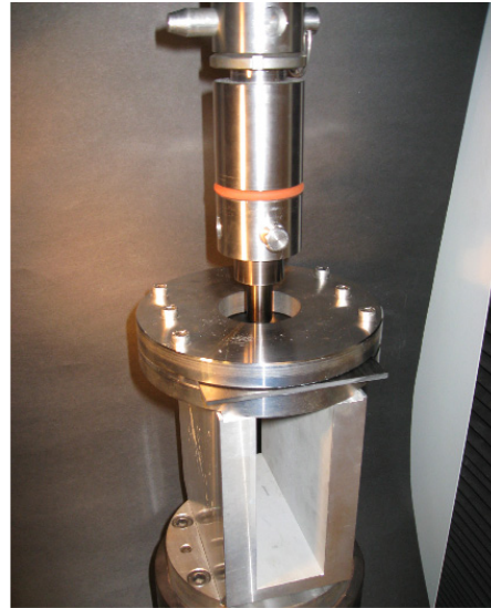
FIG. II.29 - Montage de poinçonnement avec les flasques afin de limiter l'étendue des délaminages
