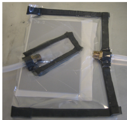
FIG. II.38 : Réalisation d'une réparation par infiltration sur éprouvette endommagée par impact
