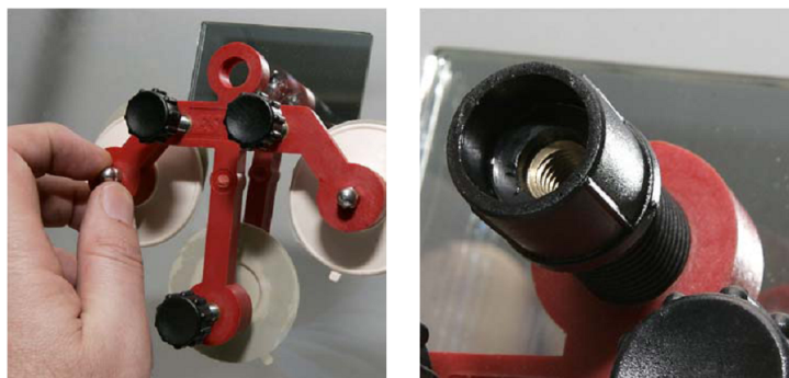
FIG. II.42 - Exemple de système industriel qui permet de faire une infiltration avec une pression d'injection pour la réparation d'un pare-brise grâce à un ensemble fileté et des ventouses ( http://www.espritws.com )
