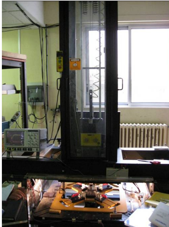
FIG. II.26 - Machine d'impact permettant de réaliser des impacts de 0,5J à 1000J
