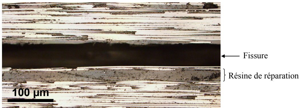
FIG. III.31 – Observation microscopique de l'interface délaminée par essai DCB sur une éprouvette réparée par XU3508/XB3403
