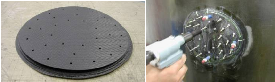
FIG. I.29 - Solution hybride de patch riveté/collé d'Eurocopter [Brunel, 2007]
