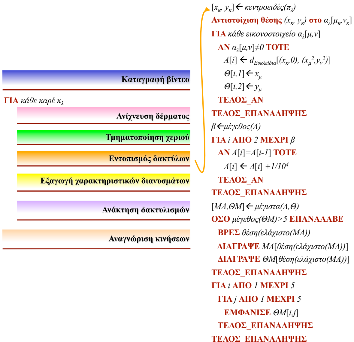
Σχήμα 5.6.3.2 Αλγόριθμος εντοπισμού θέσης άκρων και ταυτοποίησης δακτύλων
