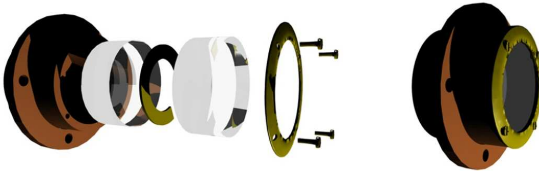
FIGURE 2.9: Schéma du nouveau système de montage de la cavité à miroirs cylindriques.
