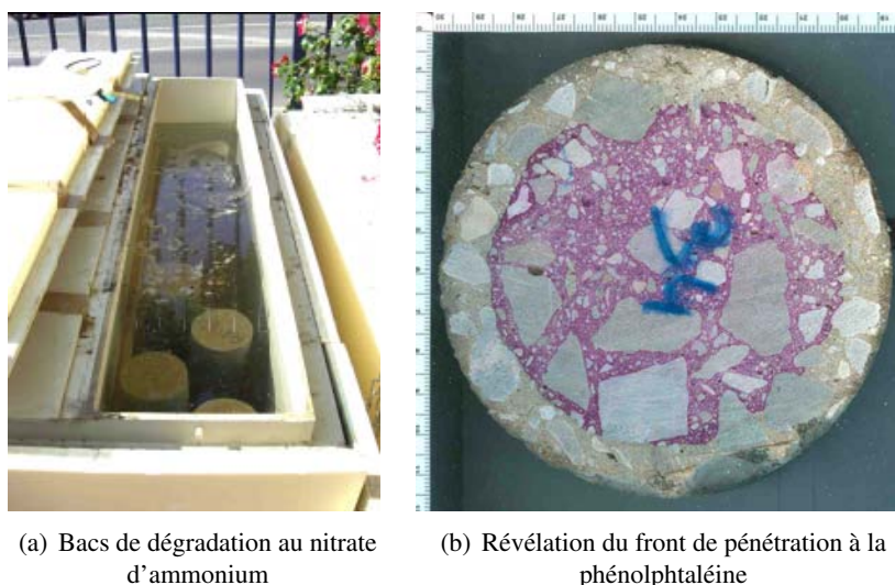
FIG. 1.9: Essai de dégradation accélérée au nitrate d'ammonium
