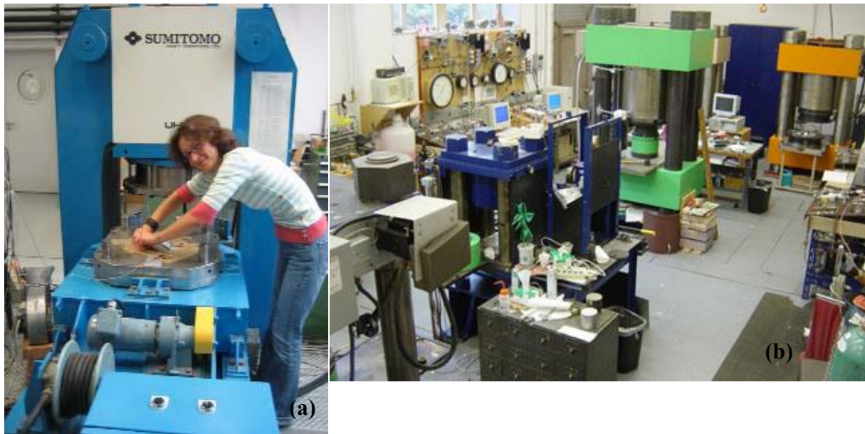
Figure 2.1.3 (a) Photo de la presse Sumitomo, 1200 tonnes, utilisée au cours de cette étude à Bayreuth, Allemagne. Je suis en train de mettre en place un assemblage en vue d'une expérience HP-HT (b) Photo du laboratoire de haute pression de la Carnegie Institution, USA. On distingue les deux presses multi-enclumes, 1500 tonnes, utilisées au cours de cette étude.
