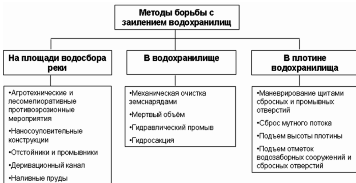
Рис.1.5. Методы борьбы с заилением водохранилищ
