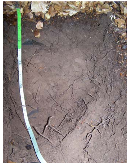
6 7 8 9 10 11 Fig. 4.5 : Limite entre la litière et l'horizon A diffuse et ondulée, alocrisol sous hêtraie pure, sur roche mère volcano-sédimentaire, Bitschwiller-les-Thann, 68 (photo D. Schwartz).
