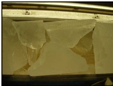
Figure 6: Photo de carotte de glace de Talos Dome prélevée dans la « brittle zone » : zoom sur les fractures illustrant la fragilité de cette section de la carotte de glace.
