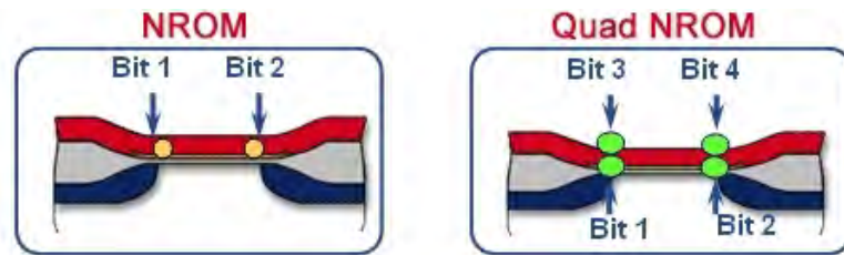
FIG. 1.16 – Cellule mémoire 4-bits. D'après [SAIFUN, 2003].
