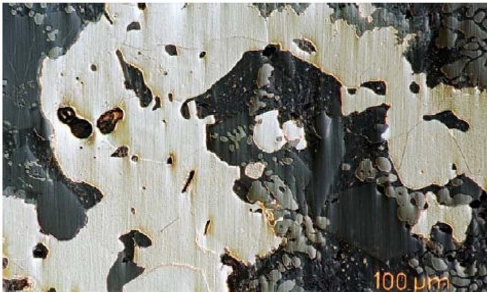
**Figure 13:** Filament métallique après attaque nital MO (GL04-07).
