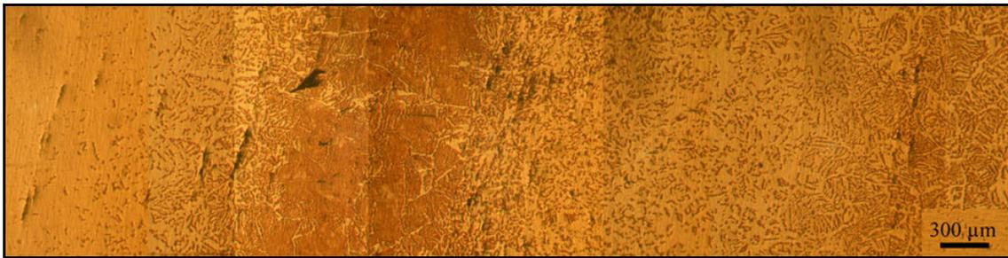
**Figure 7** : Mise en évidence (attaque nital) de l'hétérogénéité de la teneur en carbone d'un fer de construction de la cathédrale Notre Dame de Rouen (ROU314) [50]<sup>51</sup>.
