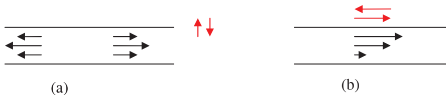
Figure 2-1 (a) Fluide modélisé par l'équation de Reynolds (b) Fluide modélisé par un écoulement de Couette. Le profil de vitesse apparaît en noir alors que le mouvement de la plaque est décrit par les flèches rouges.
