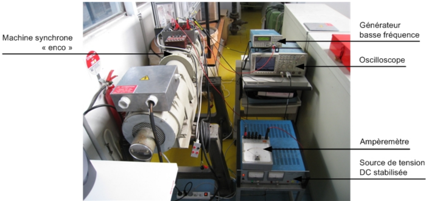
Fig. III.12. Banc de mesures du test SSFR modifié de la machine synchrone « Enco »
