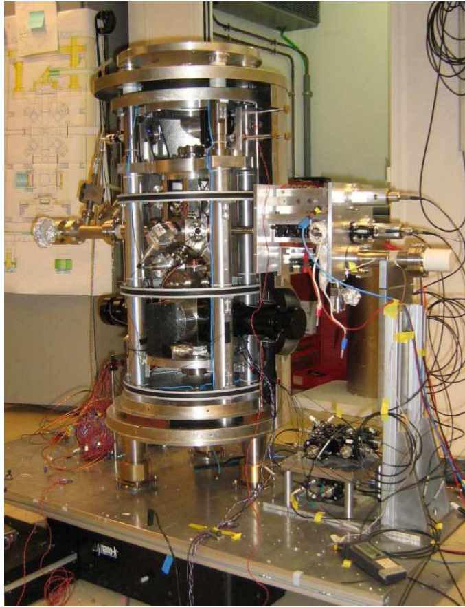
FIG. 6.1 – Vue d’ensemble du nouveau gravimètre atomique assis sur sa plate-forme anti-vibration
