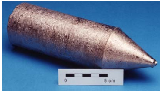
Figure 1 : Alliage (environ 1,5 Kg) de composition Ni_{45}Co_5Mn_{37.5}In_{12.5} après fusion par induction
