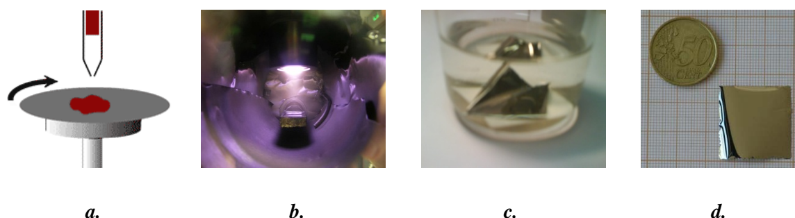
Figure III.1.a. Dépôt de la résine S1818 sur Al_2O_3 par spin-coating. b. Dépôt du film Ni-Mn-Ga sur le composite S1818/ Al_2O_3 par pulvérisation cathodique magnétron. c. Libération du film Ni-Mn-Ga par dissolution de la résine S1818 dans l'acétone. d. Photo du film libre ainsi obtenu.
