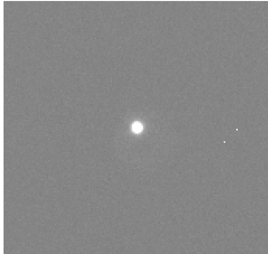
FIGURE 8.10 – Exemple d'imagette de \sim 250 \times 250 px obtenue à l'issue des premiers réglages optiques d'ASTEP400 à Concordia, le 28 novembre 2009, au centre du champ. Seule l'étoile Canopus est visible de jour, grâce à un filtre H\alpha .
