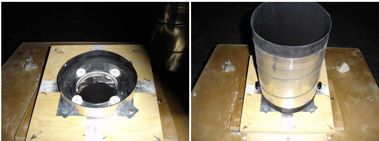
FIG. 5.28 – Installation du pare-lumière autour du hublot de l'enceinte thermalisée d'ASTEP Sud, au cours de l'hiver 2009. Le but est d'éliminer les reflets parasites. Le pare-lumière fait environ 40 cm de haut.
