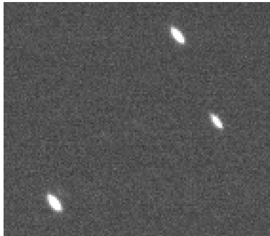
FIG. 5.2 – Portion d’image de 150 \times 150 px centrée sur le pixel (3655,3610) montrant l’étalement des PSF en bord de champ.
