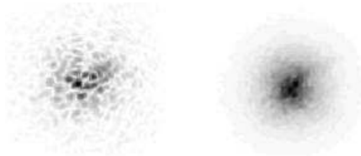
FIG. 2.3 – Effet de la turbulence atmosphérique au foyer d’un télescope. Gauche : temps de pose court (~100 ms), droite : temps de pose long (> 1 s).
