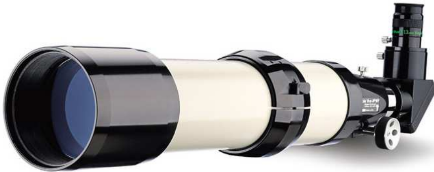
FIG. 4.6 – Lunette Télévue NP101, choisie pour l'instrument ASTEP Sud.
