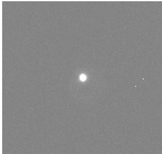
FIG. 7.10 – Exemple d’image de \sim 250 \times 250 px obtenue à l’issue des premiers réglages optiques d’ASTEP400 à Concordia, le 28 novembre 2009, au centre du champ. Seule l’étoile Canopus est visible de jour, grâce à un filtre H\alpha .
