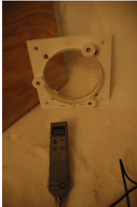
FIG. 4.8 – Test du hublot dans un congélateur à -80^{\circ}\text{C} . On n'observe aucune formation de givre entre les deux lames.
