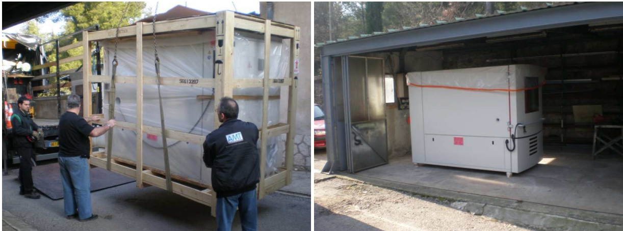
FIG. 6.31 – Installation de l’enceinte thermique au Mont Gros à Nice. Cette enceinte permet de tester les éléments du télescope sous les températures du Dôme C.
