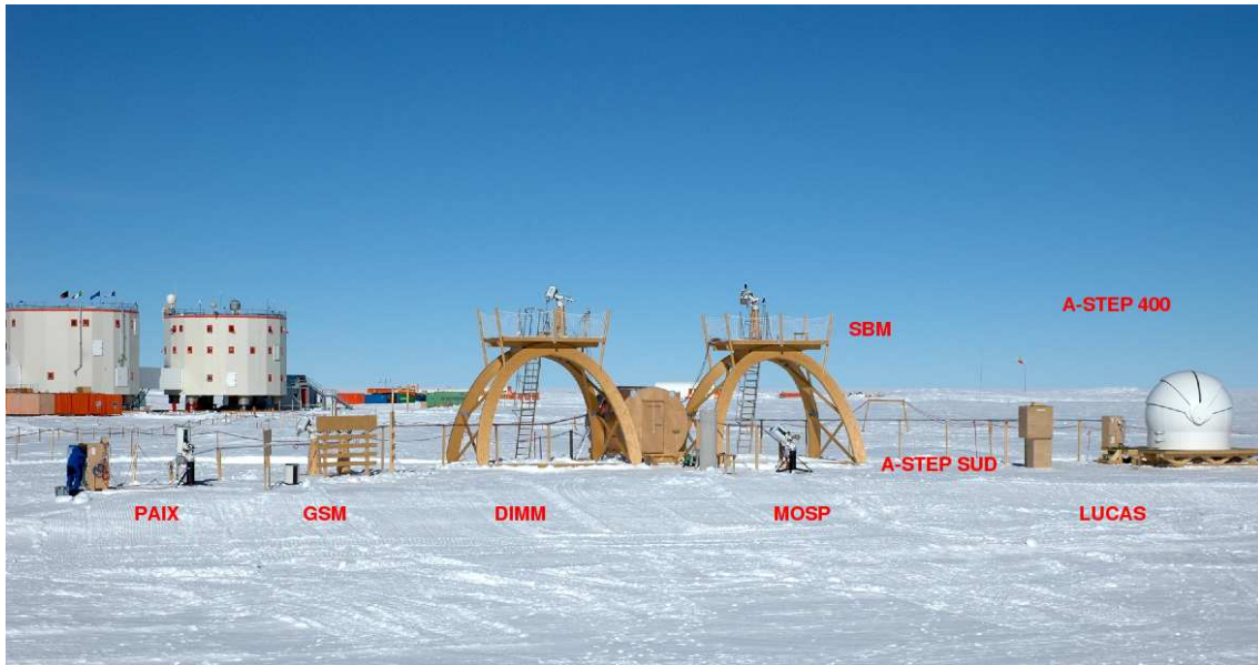
FIG. 1.12 – La station Concordia et la plateforme Astroconcordia, espace dédié aux instruments d'astronomie. Les instruments sont soit au niveau du sol, soit sur une structure en bois de 8 m de haut. Un abri en bois relié à la station contient les ordinateurs et les appareils permettant de faire fonctionner les instruments.
